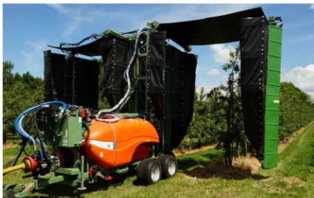
Projekt ALVO-TECH-TRANSFER „Wissenstransfer und Technologieanpassung im Erwerbsobstbau im Sondergebiet des Alten Landes“ Überprüfung der Praxisstauglichkeit und biologischen Wirkung von Tunnelsprühergeräten mit 90% Abdriftminderung und Recyclingeinrichtungen zur Reduktion des Pflanzenschutzmitteleinsatzes. Eine technische Möglichkeit die geforderte Risikominderung im Rahmen der Altes Land Pflanzenschutzverordnung (ALVO) zu erfüllen. (Foto: J.-P. Raiflis)
