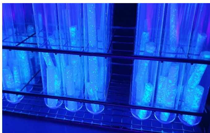
Abb. 29 Messträger in Rollrandgläsern (Filterpapier) nach erfolgter Applikation mit Pyranin 120% Nachweisstoff unter UV-Licht.
