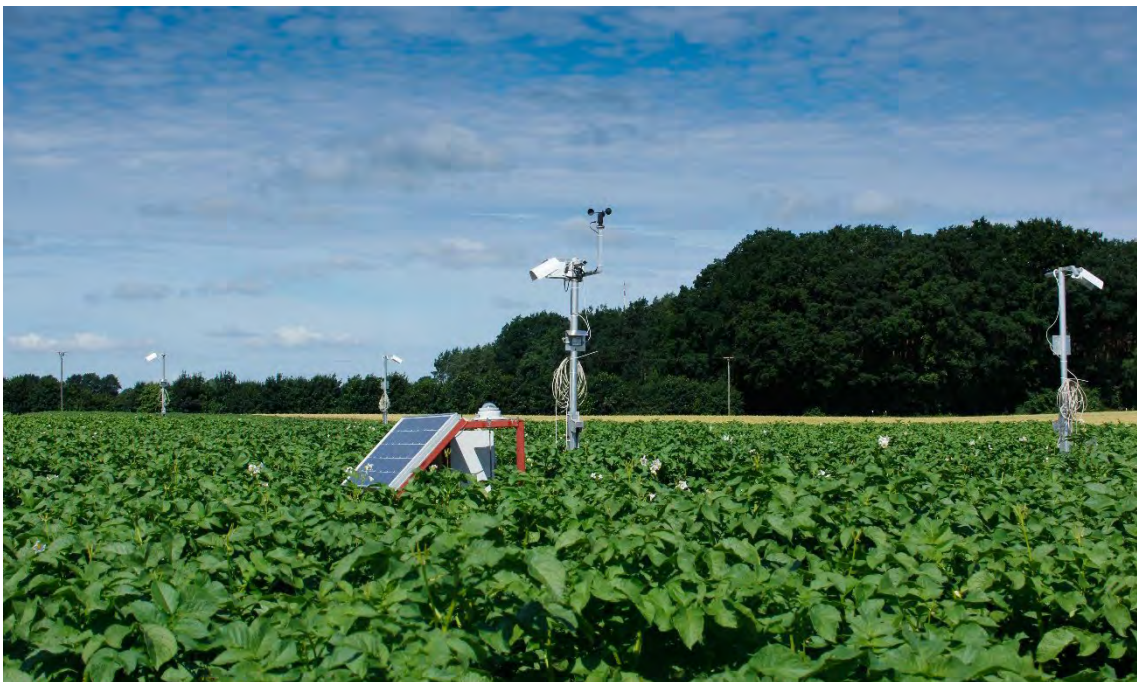
Abbildung 35: Thermosensoren zum erfassen des Trockenstress in Kartoffeln auf dem Versuchsfeld in Hamerstorf (Foto: Christine Schröder, Ostfalia Suderburg)
