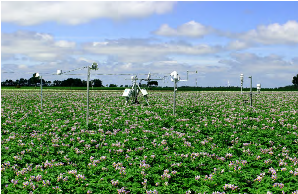
Abbildung 18: Messaufbau am Standort „Niendorf groß“ im Versuchsjahr 2018 mit der Stärkekartoffel Axion. Zu sehen sind die Wetterstation (rechts), die Eddy-Kovarianz Station (mittig) und ein Teil des Messkreises, welcher die Bestandstemperatur misst (mittig bis links), (Foto: Thünen-Institut)
